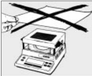
Das Gerät gibt durch das Gitter in der Haube während des Betriebes Hitze ab. Es darf daher in betriebsbereitem Zustand und während des Betriebes nicht abgedeckt werden!
